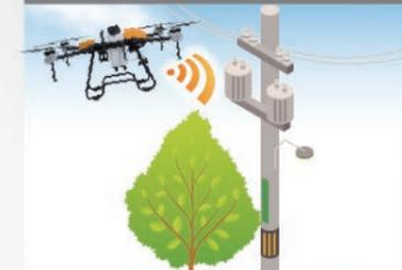
障害物を検知すると自動で飛行停止してホバリングし、補助ブレーキのような役割を果たします。
