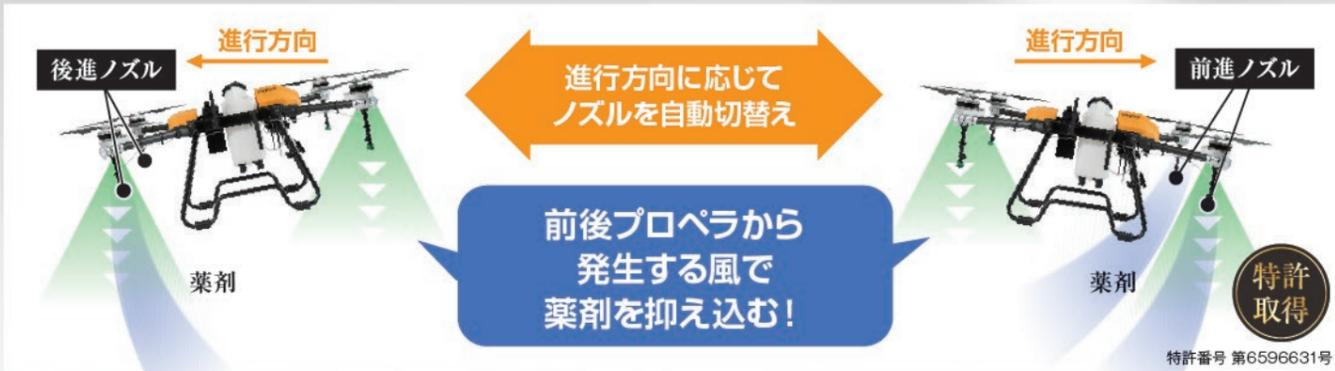
プロペラが大きいほど降下気流の中に薬剤を留めて散布することができるため4枚プロペラを採用。吐出ノズルは進行方向に応じて前後自動で切り替わります。これらを組み合わせることによって、作物の葉裏や根元まで均一に薬剤散布できる特許技術を搭載。マゼックス独自のこの散布方式により飛助15は無人ヘリコプターと同等の散布性能を誇ります。
