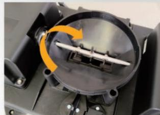
強力なトルクと装置内部に攪拌装置が搭載されたことで薬剤の詰まりを軽減します。
